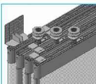
Sistema de fijación de paneles mediante clipaje para agrupar todas las hojas cuando las plegamos, manteniéndolas siempre unidas.
